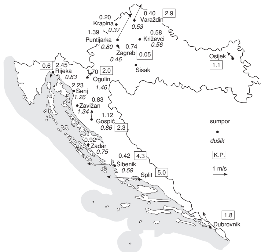
Slika 13. Ukupno mjesečno taloženje sumpora iz sulfata i dušika iz nitrata (kg/ha), prosječna brzina i smjer strujanja, te koeficijent provjetravanja (K.P.) u Hrvatskoj za STUDENI 1996. godine
