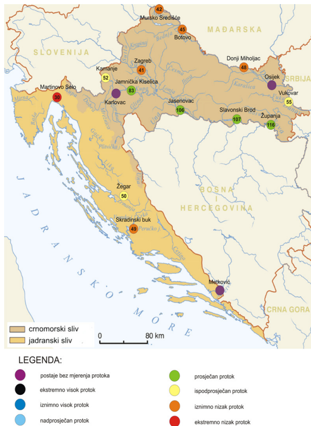
Slika 24. Lokacije hidroloških postaja sa prikazom srednjeg mjesečnog protoka za TRAVANJ 2026. izraženog u postotku u odnosu na prosječni srednji mjesečni protok u istom mjesecu za razdoblje 1991. – 2020. godine
